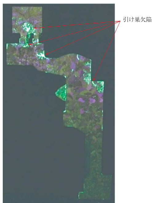
第13図 現行方案での代表的な引け巣欠陥発生箇所
