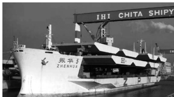
第 8 図 桁積み込み完了後の輸送船（第 1 船） Fig. 8 Transportation ship with deck units doubly stacked (first shipment)
