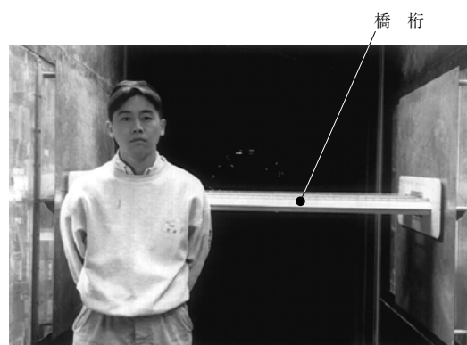
第 3 図 IHI 構造物安定性風洞と縮尺 1/80 橋桁部分模型 Fig. 3 1:80 scale bridge deck model mounted in the IHI 1.5 m × 2.5 m wind tunnel
