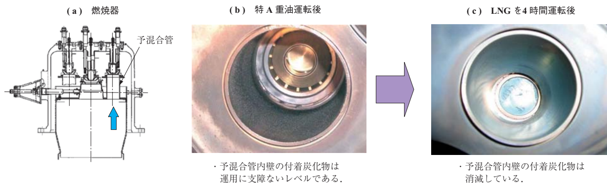
第 9 図 予混合管の付着炭化物の状況
