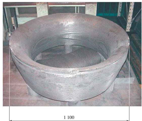
第 1 図 C/C 複合材ロケットノズル ( 単位 : mm )
