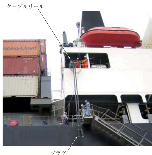
第 4 図 ケーブル繰出し状態 Fig. 4 AMP cable reel-out operation
