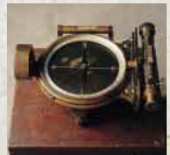
安積疏水開削の際に使われたトランシット（測量器械）
