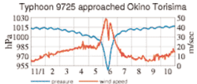
図9 沖ノ鳥島で観測された台風9725号通過時の気圧及び平均風速の変化(風速値のピークの中央部に明かな風速の落ち込みがみられる。)
