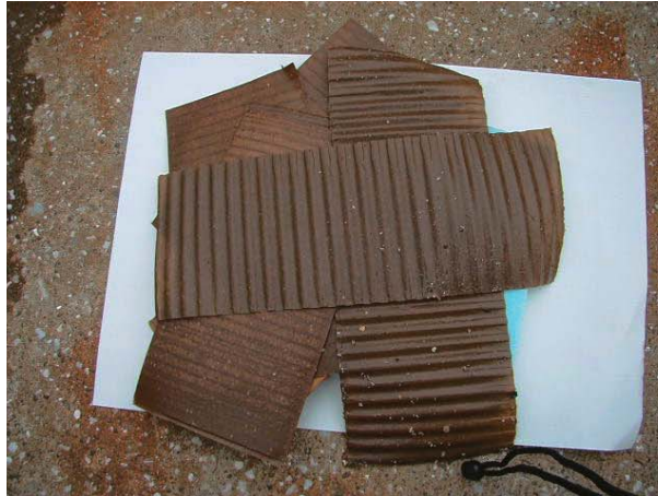
図9a 海水沈没後3時間での段ボール片の様子。左がワシントン大学製緩衝容器で用いられている段ボール片，右が日本製の段ボール片。
