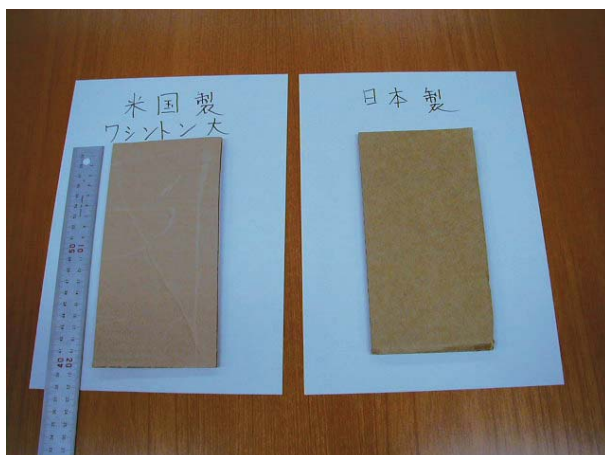
図8b 海水沈設実験に用いた段ボール片。左がワシントン大学製緩衝容器で用いられているもの、右が同じ強度を持つ日本製の段ボール片。
