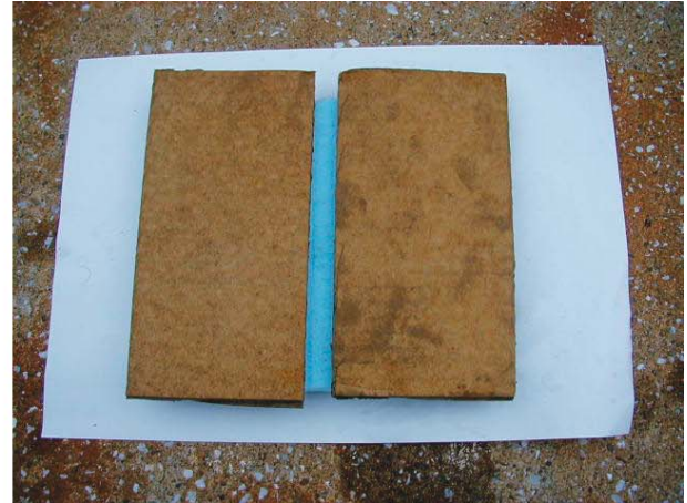
図9a 海水沈没後3時間での段ボール片の様子。左がワシントン大学製緩衝容器で用いられている段ボール片，右が日本製の段ボール片。
