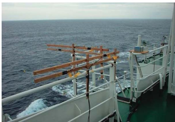
写真2 八木アンテナ。「みらい」のコンパスデッキ右舷側に設置したところ。
