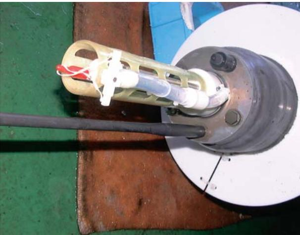
写真9 回収されたフロートQ2900186の安定板(a)およびセンサー部(b)。
