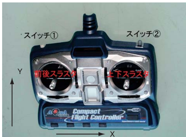
図6 リモートコントローラ操作パネル
