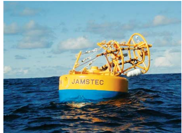
写真1 Vandalismにより折られたアルミ製のタワー。アルミ製のタワーの損傷は16例にのぼる。
