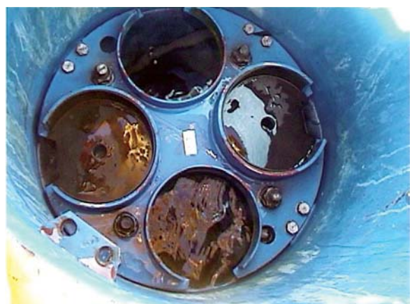
写真3 ブイ本体内部の電装容器の盗難
