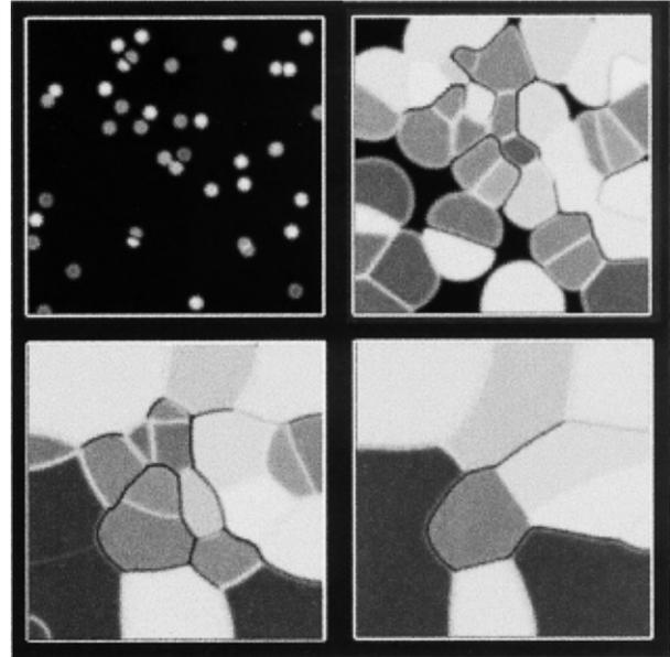
Figure 2 核生成から凝固，グレインバウンダリの形成，再結晶過程までのシミュレーション。
