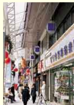
アーケード内の温熱環境についての調査の様子(2001年1月、長崎市にて。中央の三脚に様々な測定用センサーを設置。天井から吊り下げたロープに温度センサーを取付。)
