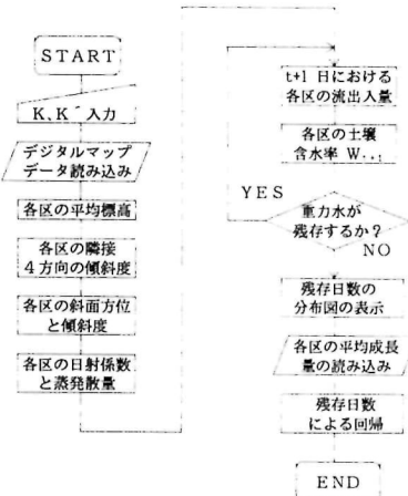
図-2 土壌重力水の残存日数計算 (プログラムのフロー図)
