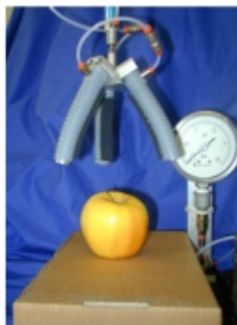
図8 弾性体空圧アクチュエータ果実収穫用ロボットハンドへの応用 20)
