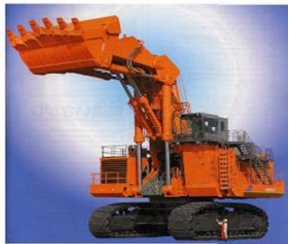
写真1 超大型ショベル (自重：800t：日立建機)
