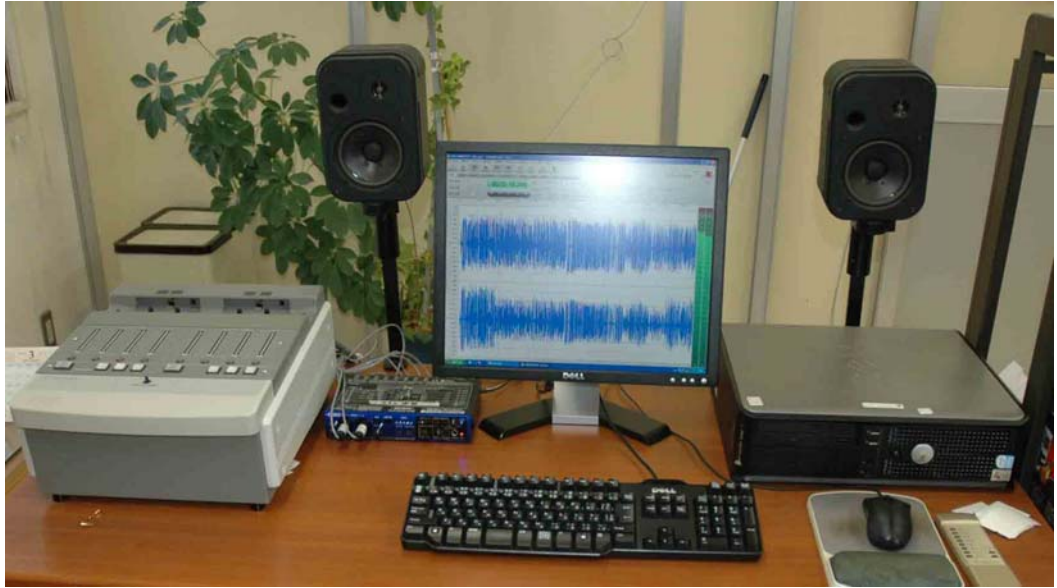
カセットテープのデジタル変換用機材設置の様子 (左から、カセットテープ再生機・A/D 変換器・デジタル音声データ取り込み変換処理用 PC)
