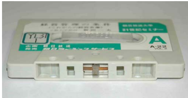
修復対象のカセットテープ (スプライスの外れによりエンクロージャーの内部ヘテープが巻き込まれている)
