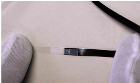
スプライスが完了した接合部(磁性面と反対側から見たところ)
