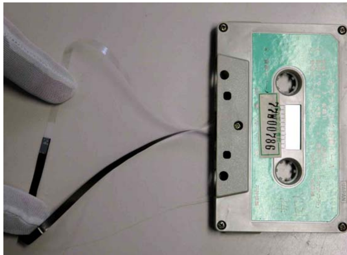
修復作業が完了したカセットテープ(あとはテープを巻き取れば完成)
