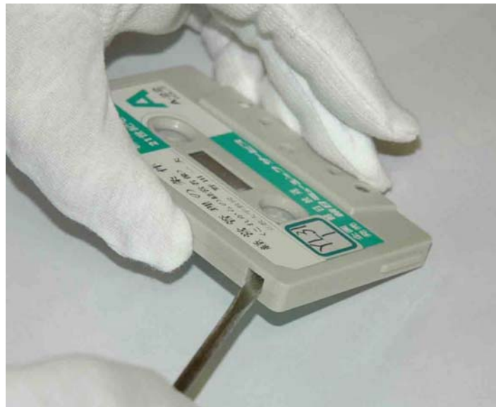
エンクロージャーの分解(溶着により固定されているタイプ)
