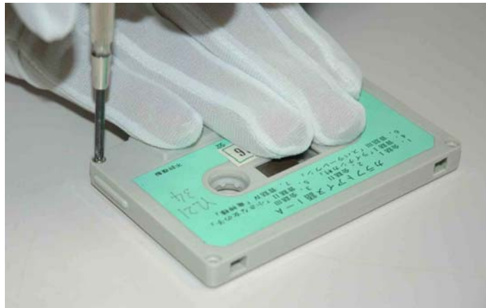
エンクロージャーの分解(ねじ止めタイプ)
