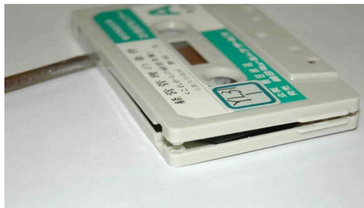
エンクロージャーの分解(溶着により固定されているタイプ) このタイプのエンクロージャーは、修復不可であるため、新しいエンクロージャーに交換する
