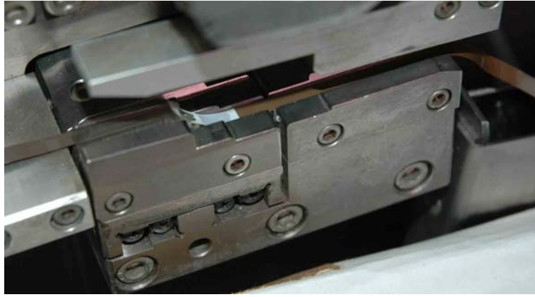
磁気テープをスプライシングブロックに定置する(バキュームで保持される) テープの表裏やねじれに注意する
