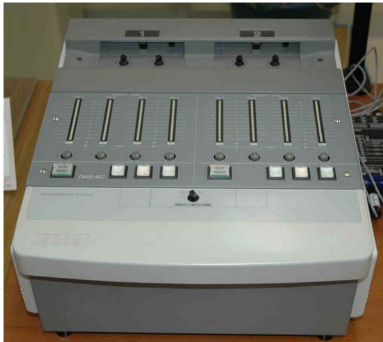
カセットテープ再生機(2倍速・AB面同時再生可能)
