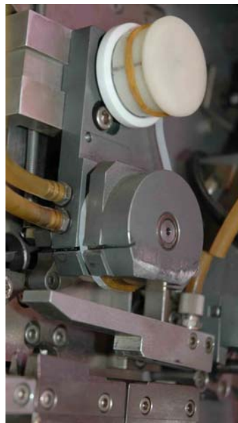
下部のスプライスブロックに向かって上からスプライシングテープを貼り付ける
