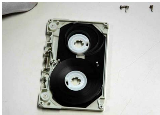
分解されたエンクロージャー(内部にテープが入っている)
