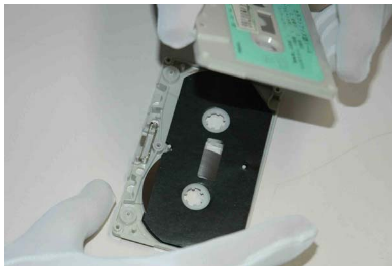
上側のシェルを取り外し、潤滑シート(上図の黒いシート)を取り除く
