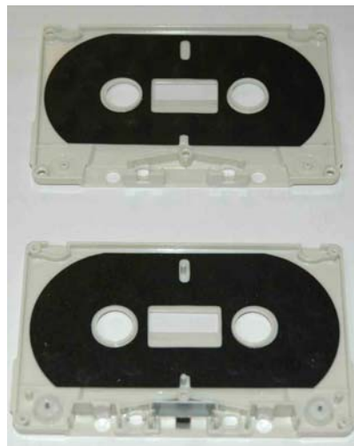
交換用のエンクロージャーを分解しておく（ねじ止めなので分解は容易）
