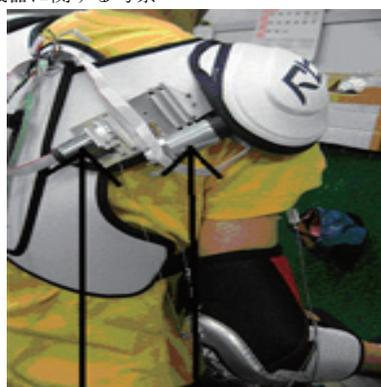
図 14 装着型力覚提示装置
