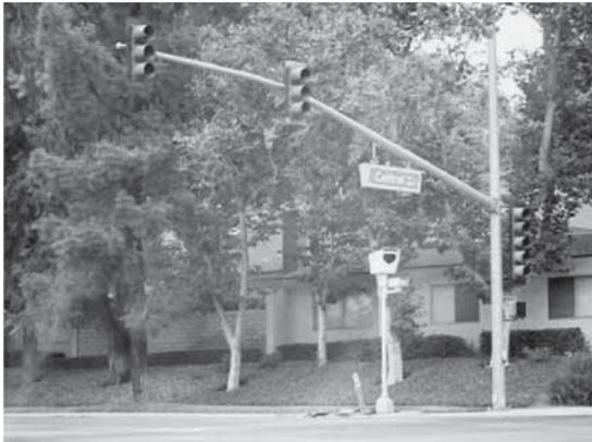
図2 信号での一時不停止のための自動違反取締装置(信号機の表札下)。方向指示器を出さずに曲がる車も多く見かけるので、規則以前に人に心配りの出来る運転マナーを持って欲しい。
