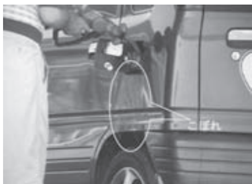
図5 レバーを引いたままノズルを引抜き給油（不適切操作事例4）
