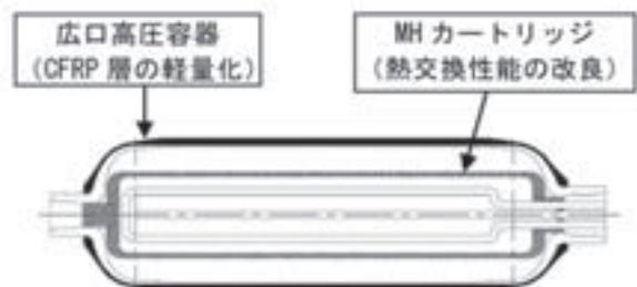
図1 ハイブリッド貯蔵タンクの改良点
