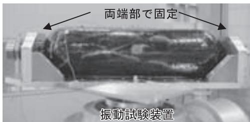
図10 振動試験時タンク設置状況
