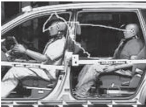
図5 ダミー頭部の軌跡（上段：シートベルト着用，下段：非着用）
