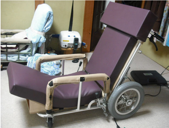
図4 第2試作(骨盤を寝かした姿勢を想定)
