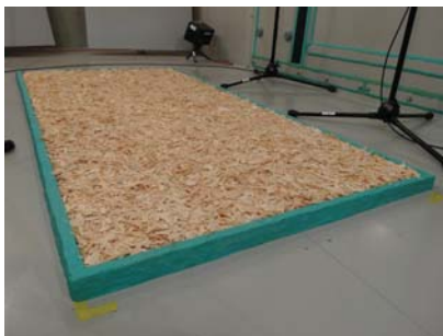
図 7 桧ストランドの設置状態
