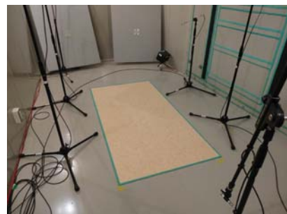
図 8 桧ストランドボードの設置状態
