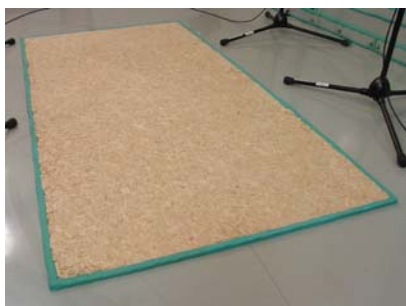
図 10 低密度桧ストランドボードの設置状態
