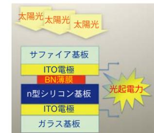
図2 BN/Siヘテロ接合太陽電池の仕組み。透明なサファイア基板とITO電極を透過した太陽光がBN薄膜/シリコン基板ヘテロ接合構造部に到達し、光励起により発生した電位差が上下の透明ITO薄膜電極間から光起電力として取り出されます。
