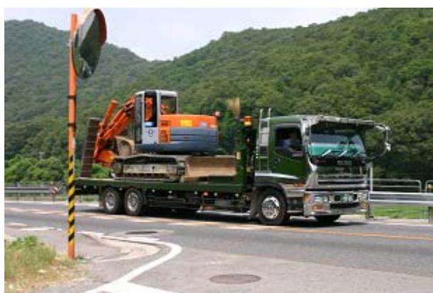
写真-5 試験車両 (セルフローダ+バックホー)
