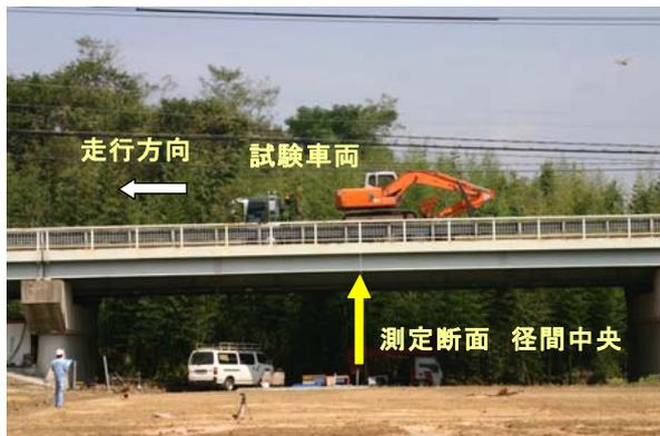
写真-10 試験車両の下り車線走行
