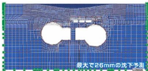
図-20 FEMによる非開削掘削解析<sup>5)</sup>
