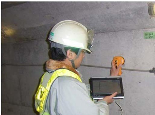
写真-1 ひび割れ幅測定状況
