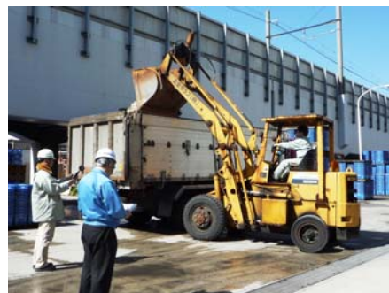
写真-1 作業音の計測風景
