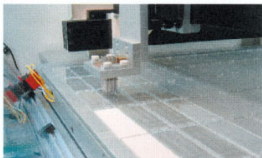
16本のピンでDNA溶液を吸い上げる
