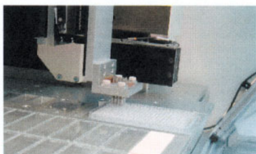
吸い上げたDNA溶液を、スライドガラスにスポットする
