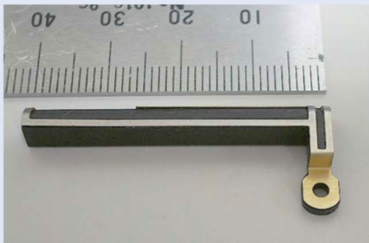
多機能・小型化を実現したマルチバンドアンテナ
