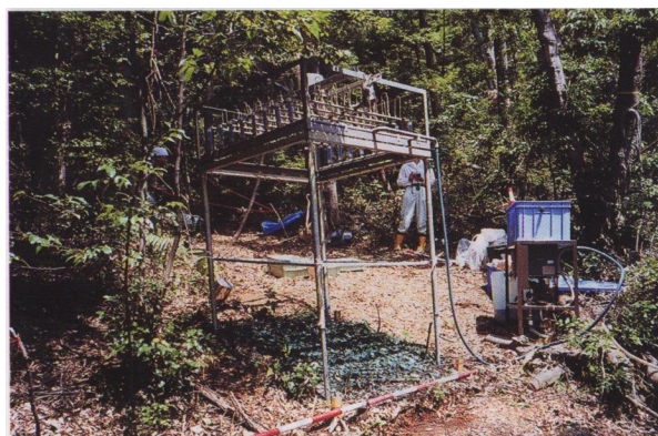
写真-1 人工降雨装置（立田山実験林内）
