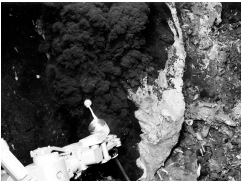
摂氏360度のブラックスモーカーを噴出する熱水噴出孔「かいこう」のマニピュレーターで温度計測をするところ
