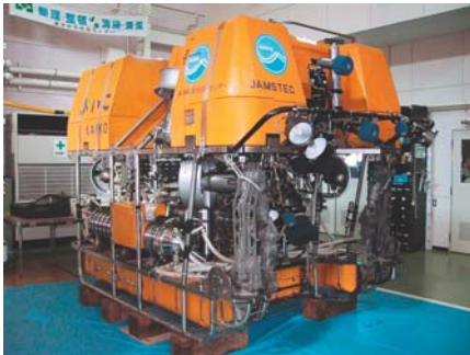
無人探査機「かいこう」ビークル L3.1m×B2.0m×H2.3m 空中重量5.3t
