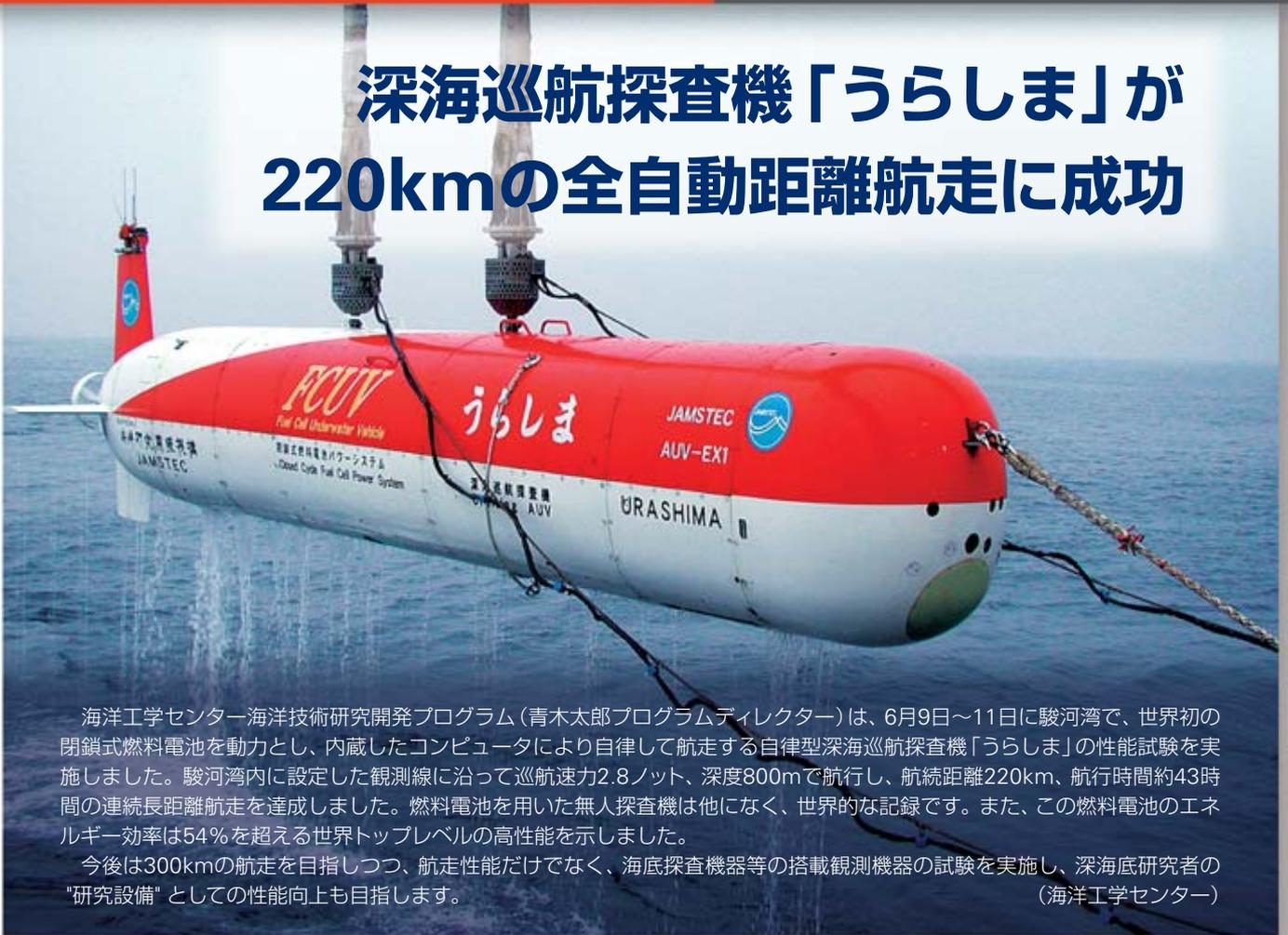
海洋工学センター海洋技術研究開発プログラム(青木太郎プログラムディレクター)は、6月9日～11日に駿河湾で、世界初の閉鎖式燃料電池を動力とし、内蔵したコンピュータにより自律して航走する自律型深海巡航探査機「うらしま」の性能試験を実施しました。駿河湾内に設定した観測線に沿って巡航速度2.8ノット、深度800mで航行し、航続距離220km、航行時間約43時間の連続長距離航走を達成しました。燃料電池を用いた無人探査機は他になく、世界的な記録です。また、この燃料電池のエネルギー効率54%を超える世界トップレベルの高性能を示しました。
