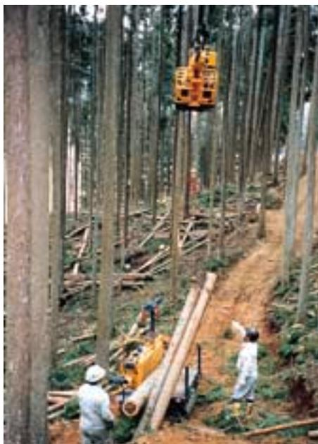
図3 ラジキャリアによる集材作業
