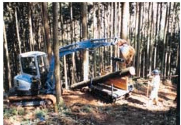
図4 ミニバックホウによる集材作業
