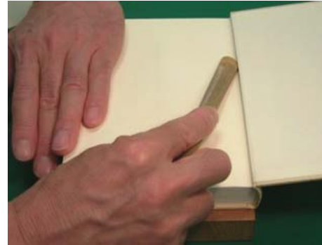
⑫力を入れ過ぎないように注意しながら、へらで見返しをのど部分に向かって押し込む。
