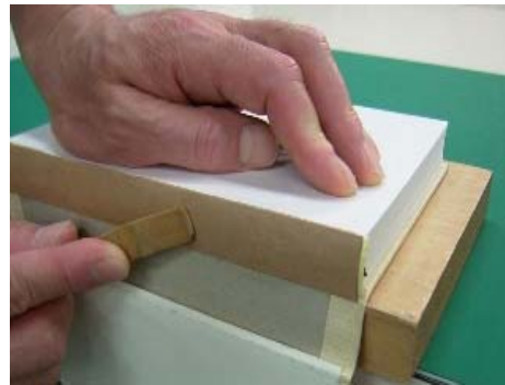
⑧貼り残しがないように、へらで圧着させる。
