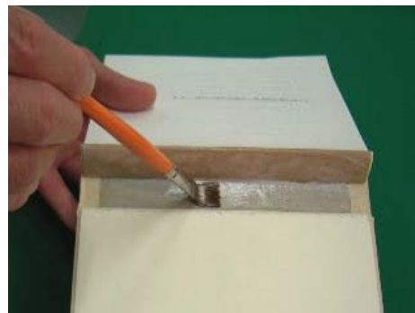
⑩筒に塗ったボンド糊が乾かないうちに、表紙の背にもボンド糊を塗る。
