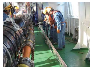
写真1. エアガン投入作業
