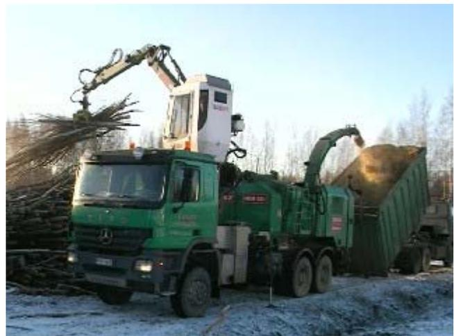
写真 1 4 チップパー付トラックによるチップ化作業(輸送トラックはトレーラーにさらに 2 コンテナ積載)
