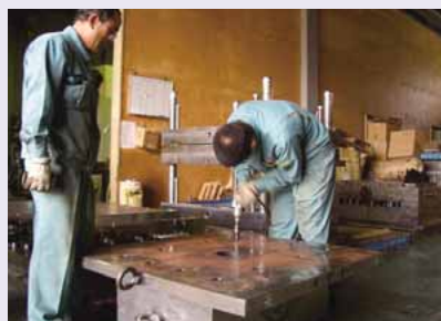
金型の分解・組立て作業
