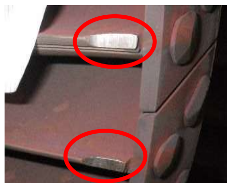
動翼と静翼の接触状況(動翼側)
