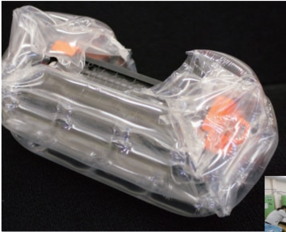
空気の入った「エアーカーrier」に包まれたコピー機の部品
