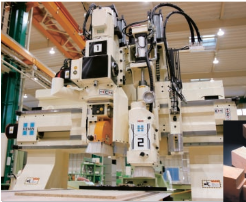
木工床用のプレカットマシン。今にも動き出すロボットのような
