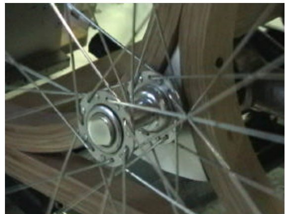
Fig.3 竹製車椅子の車軸受け部の緩み
