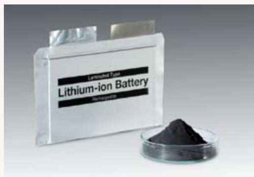
写真：リチウムイオン電池用カーボン負極材
