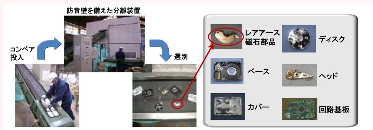
写真：ハードディスクドライブ分解の流れと分離・回収されたレアアース磁石部品
