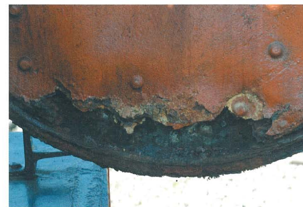
《二号機関車》ボイラー内部の腐食状況（加悦SL広場：明治6年製） 錆の進行を抑えるための処置を行いました。 Corrosion of the inside of the boiler in Steam Locomotive No.2 made in 1873 (Kaya Steam Locomotive Square) The boiler was treated for corrosion.
