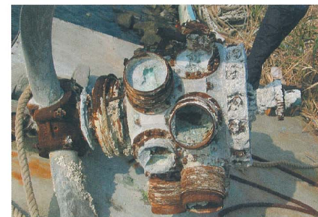
東京湾より引き上げられた航空機用エンジン 現存する唯一の《陸軍二式戦闘機 鍾馗》のものと推定され、現在航空自衛隊入間基地で修復中です。 Aircraft engine salvaged from Tokyo Bay This is presumed to be a part of Type 2 Fighter Shoki and is being restored at Iruma Base of the Japan Air Self-Defense Force.
