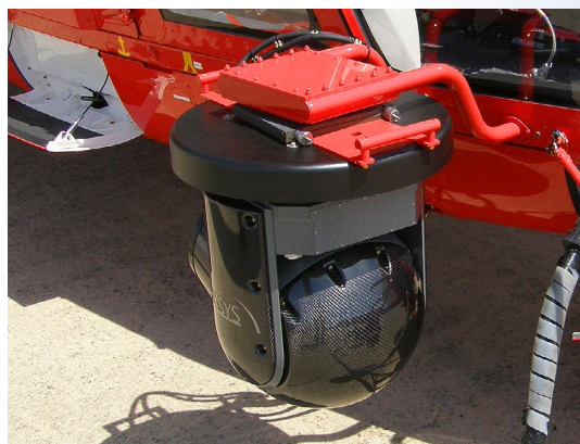
ヘリコプターテレビ電送システム（カメラ部分）
