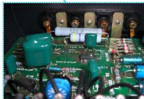
負荷保護用継電器 (プリント基板被水)
