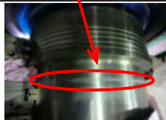
②回転子主軸 接触痕有り
