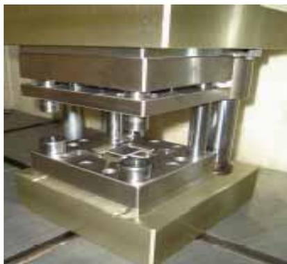
写真1 超精密リード切断金型
