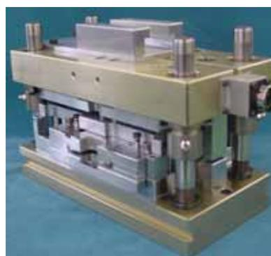
写真2 マトリックスリードフレームの1個抜き精密金型
